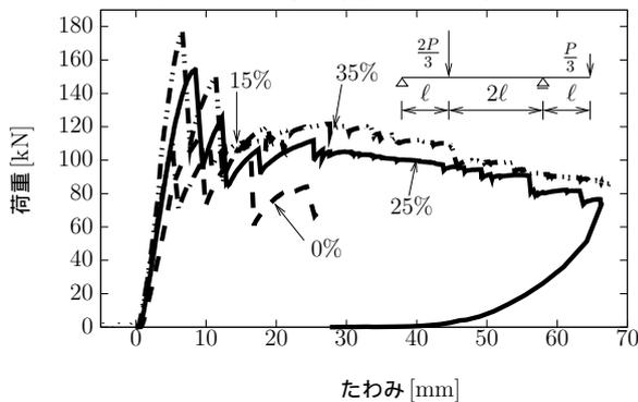
図-6 カラマツ材の荷重たわみ曲線
