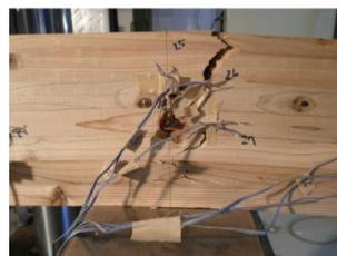
図-3 曲げ破壊
