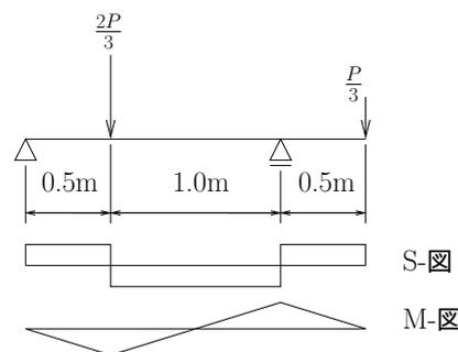
図-2 逆対称4点曲げ試験のモデル
