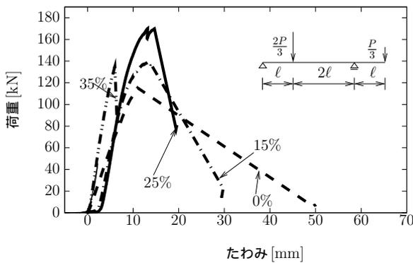
図-5 スギ材の荷重たわみ曲線
