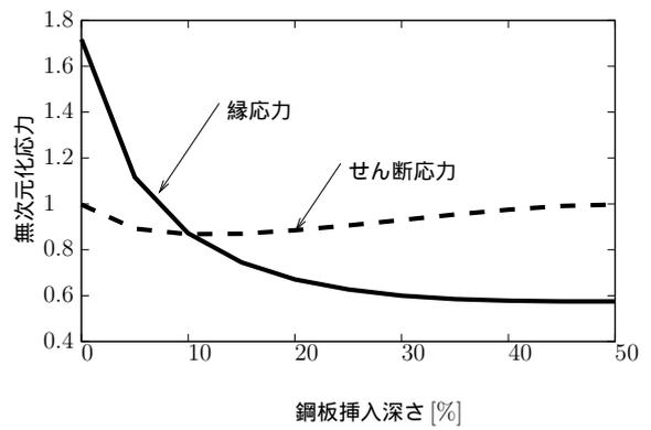
図-7 スギ材の無次元化応力
