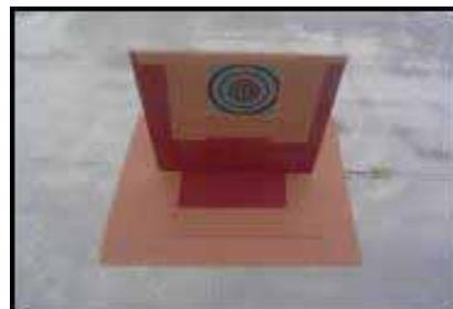
写真 5 橋脚天端反射板
