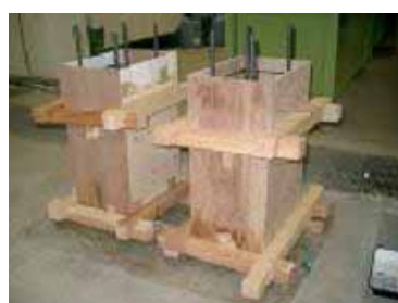
図1 20×30×50cm 供試体型枠と埋め込み鋼片
