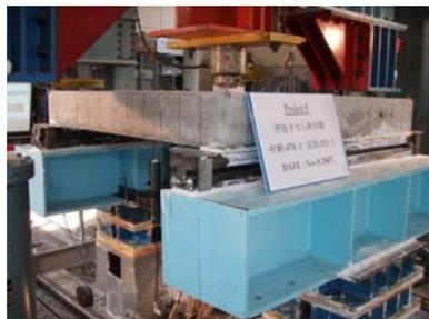
写真-1 押抜きせん断試験装置
