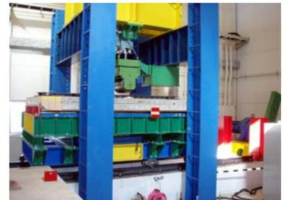
写真-2 輪荷重走行試験装置
