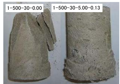
写真-1 供試体破壊状況
