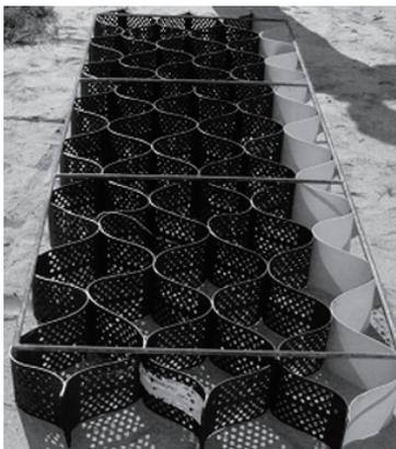
写真-1 高密度ポリエチレン樹脂製のセル (ジオセル)
