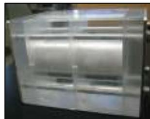
図-3 分子拡散用セル
