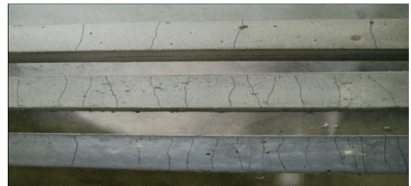
写真 4.2 実験によるひび割れ (PCM: 上、HPFRCC: 中、UHP-SHCC: 下)
