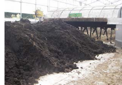
写真-4 オープン式攪拌 (施設 D)
