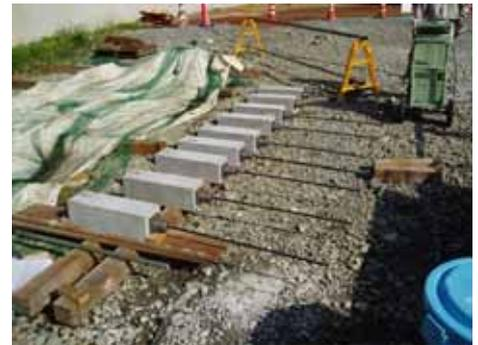
写真 - 1 暴露試験供試体
