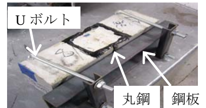
写真-1 ひび割れの導入
