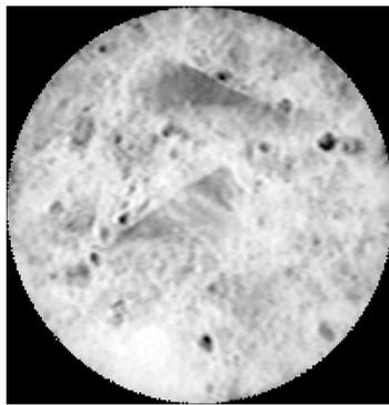
写真-2 造影剤浸漬60分後のX線造影撮影画像 (現場供試体)
