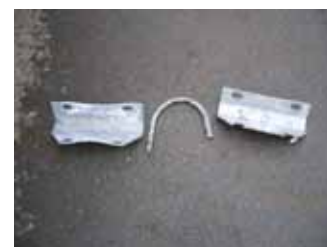
d)耐雪型ブラケット破断
