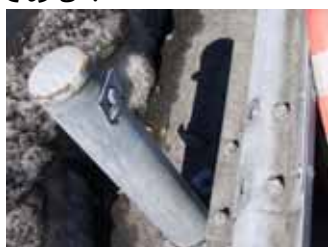
b)ブラケット破断状況
