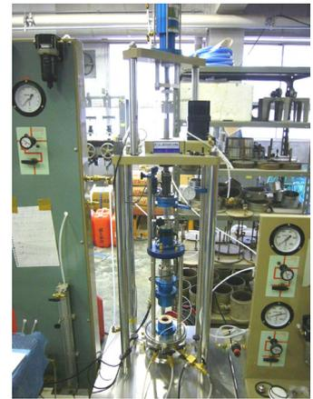
図-1 中空ねじりせん断試験機
