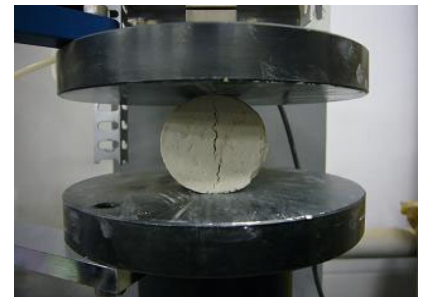
写真-2 亀裂発生
