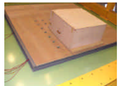
図2 a 単一ブロックモデル (傾斜台上の穴は電磁石用)
