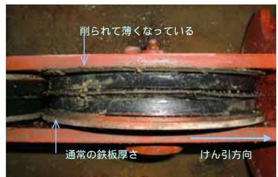
図-8 破断時の下部プーリーの状況
