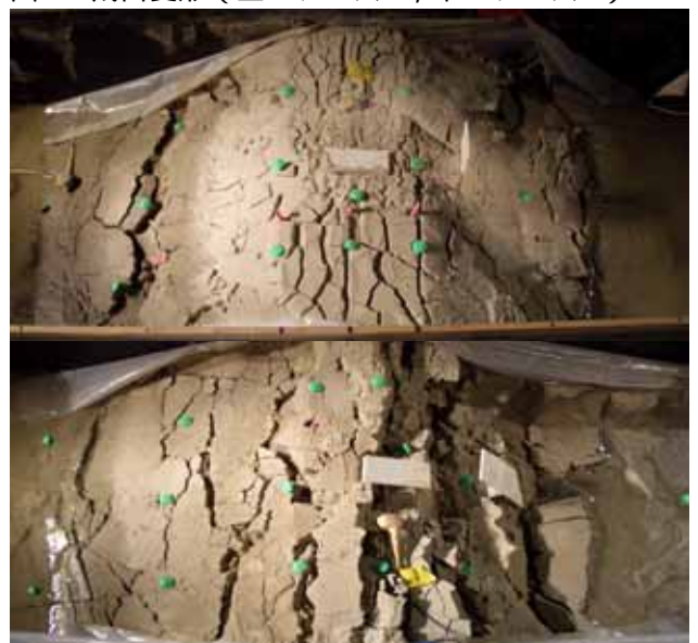
図 7 盛土の崩壊状況。上：ケース 1，下：ケース 2
