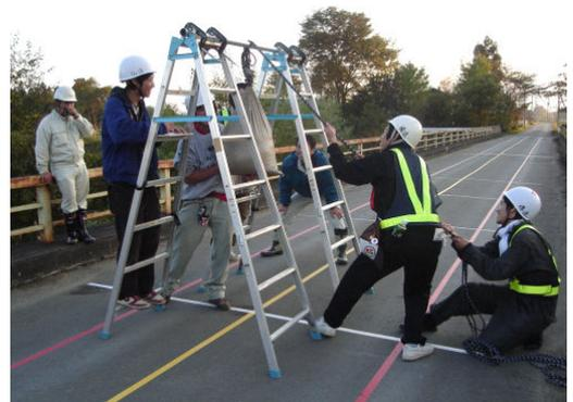
写真-1 砂袋落下試験
