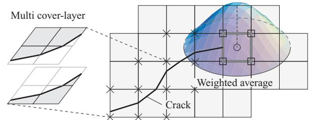
図-2 不連続変形とひび割れ判定応力
