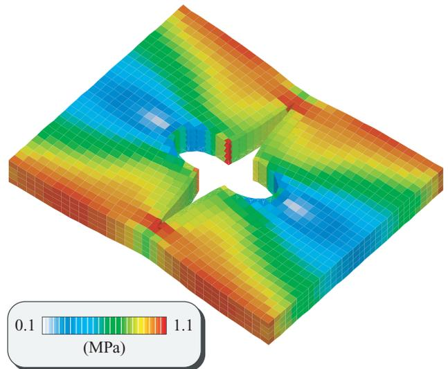
図-6 変形図(×5000)と von-Mises の相当応力分布
