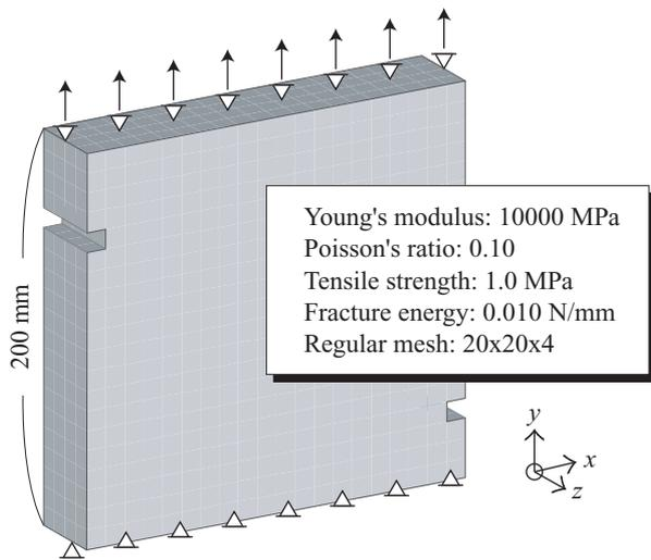
図-3 切り欠きを有する3次元構造部材
