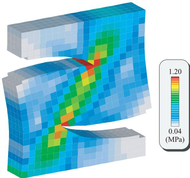
図-4 変形図(×1000)と von-Mises の相当応力分布
