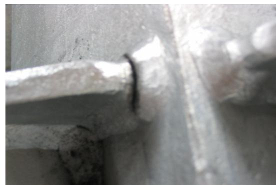
写真-1 廻し溶接部の割れ
