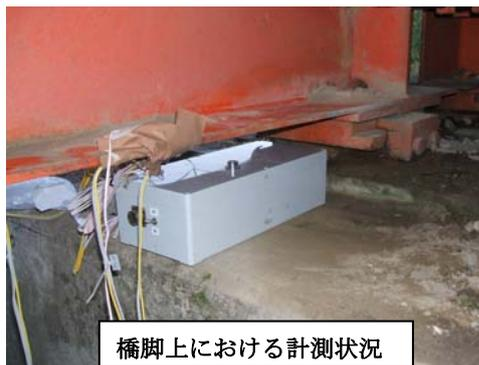
本載荷試験で使用した高精度傾斜計の仕様や実橋載荷試験時の設置方法等は、文献1)に詳細が示されている。今回は、G1桁の可動支承付近のみに、左写真の様に高精度傾斜計を設置して計測した。
