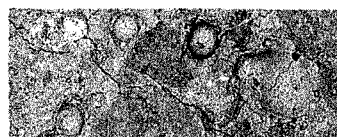
写真-3 AE コンクリート SEM 画像
