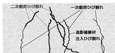
図-3 ひび割れ発生状況(二次載荷後)
