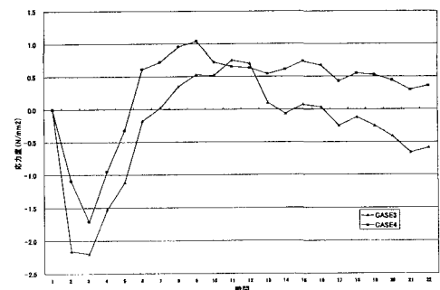
図-7 時間-コンクリート応力関係
