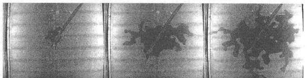
写真 2 氷板に凹凸がある場合の油拡散の様子
