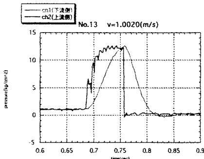
上のグラフは流速  $V=1.020(\text{m/sec})$  で実験を行い、供試体が破壊したときのグラフである。載荷時間を横軸にとり、圧力を縦軸にとった。
