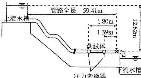
この実験装置は、全長 59.41m、高さ 12.62 m の管の内径 5.28cm の鉄管でできている。電磁弁から圧力変換器までの距離は、ch1:1.39(m)・ch2:1.80(m)である。電磁弁から
