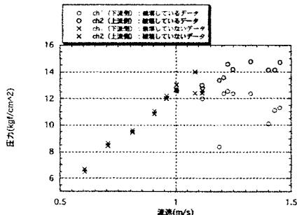
上のグラフは今回実験を行い得られたデータをもとに作成したグラフである。管路の流速を横軸にとり、圧力を縦軸にとった。破壊の原因となる水撃圧の推移をグラフに表すと、流速が速くなるにつれて圧力もほぼ比例して
