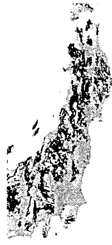
図7 地質,地形条件を変えて作成した地すべり地形分布図
