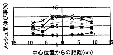
図-5(b) メッシュ間伸び率と中心からの距離 (D-D 断面 横方向)
