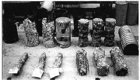
写真-2 CN 試験体の破壊状況
