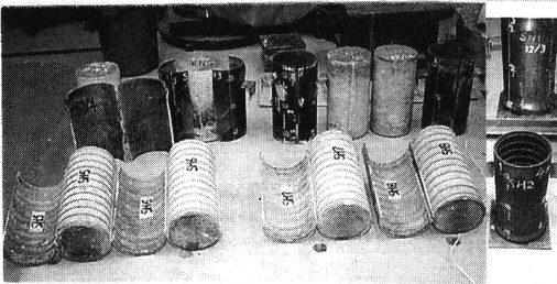
写真-1 SH、SN 試験体の破壊状況
