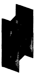
図19 斜材の追加 (最大応力 8.916E+05)
