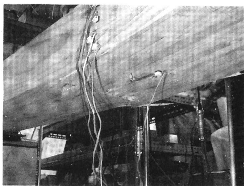
写真-2 試験桁 No. 2 曲げ破壊状況
