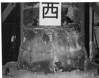
写真-2 600mm 試験体破壊形状
