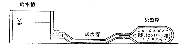
図－1 ポスト硬化式コンクリートブロックの製作方法の概念図
