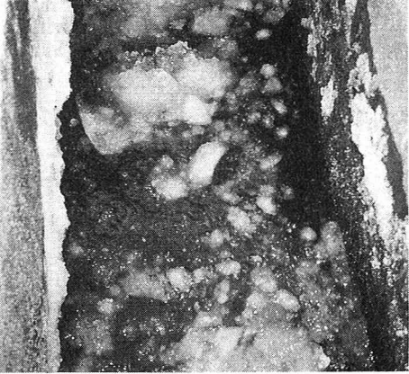
写真-1 除雪機による流雪溝への投雪および流雪溝内の流況（気温：2.6℃、水温：4.8℃、雪温：-0.2℃、雪密度：表層0.42g/cm 3 、中層0.28g/cm 3 、表面流速：0.70m/s、水深：0.19m）
