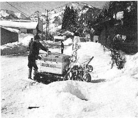
写真-1 除雪機による流雪溝への投雪および流雪溝内の流況（気温：2.6℃、水温：4.8℃、雪温：-0.2℃、雪密度：表層0.42g/cm 3 、中層0.28g/cm 3 、表面流速：0.70m/s、水深：0.19m）
