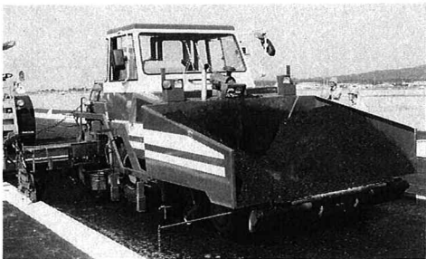
写真-1 ロボットアスファルトフィニッシュ試験機
