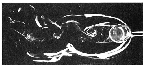
写真-1 馬蹄型渦終端部の流況 (case3)
