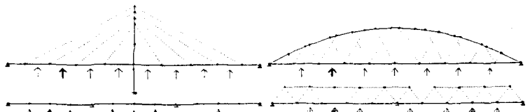
図1 各橋の加速度計設置点と解析モデル
