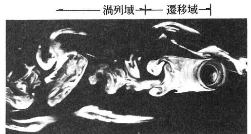
写真-1 密度界面近傍の流況 (CASE-5 +2cm)
