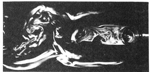
写真-2 密度界面近傍の流況 (CASE-5 +1cm)
