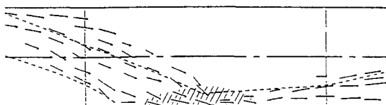
図-3 a 流速ベクトル (表面流速 Run 3)
