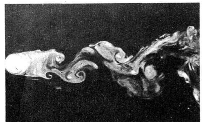
写真-1 水面付近 ( Y/h_1=0.95 ) の流況
