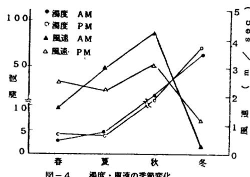
図-4 濁度・風速の季節変化
