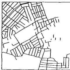
図3 シミュレーションによる被災後の南光台団地の管路網図 D=1.251 , 接点数:198
