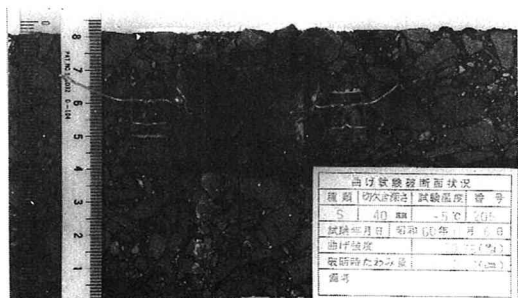
図-2 クラックゲージ接着状況
