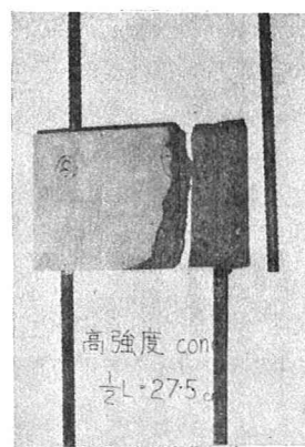
(写真-2)超高強度コンクリートの破壊例
