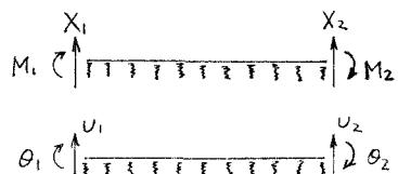
式(2)の第1項は棒の曲げの剛性マトリックス、第2項は、ばねの剛性マトリックス、第3項は座屈荷重による剛性マトリックスを表わす。特に  $\alpha=0$  として第2項を無視すると、棒の座屈の剛性マトリックスとなる。
