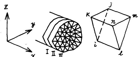
る I, II 面間の要素から得られる複素マトリクスと加え合わせると、最初の剛性マトリクスの対称性から打ち合う項が多く、結局は、1, 4, 7 行は全て実数でその他の行は全て純虚数である剛性マトリクスが得られる。これは、節点力ベクトルと節点変位ベクトルが同一の位相になることを表し、弾性波動を取り扱っているのであるから当然の結果である。同様のことと質量マトリクスについても行い、その結果を運動方程式として表すと
