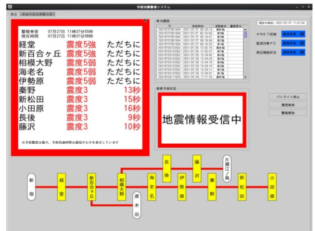
図-8 PLUM 法情報を活用した小田急電鉄の早期地震警報システムの画面例
