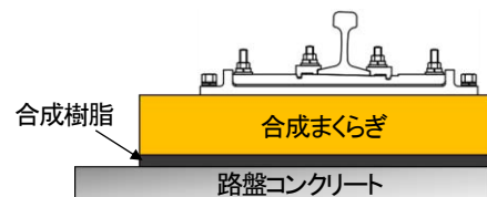
図-2 合成まくらぎ直結分岐器の構造
