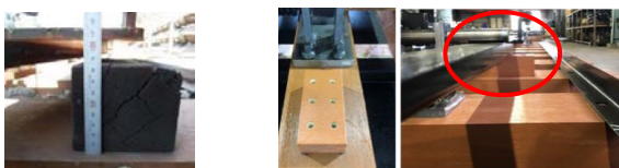
図-9 従来の木製受け台 図-10 改良した合成片の受け台
