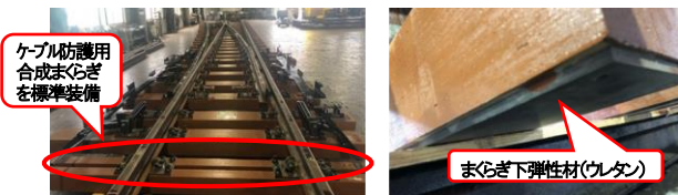
図-4 改良形可動式横取り装置用合成まくらぎ (標準仕様)
