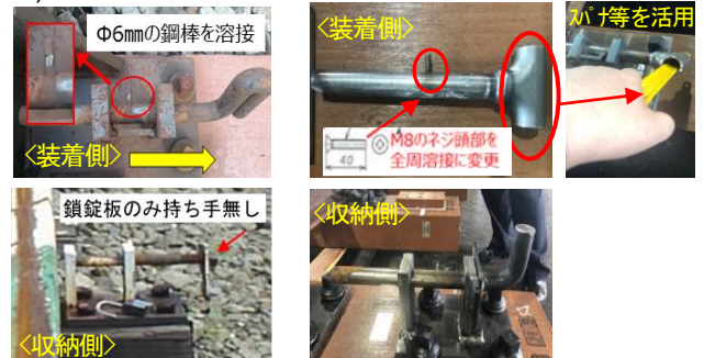
図-7 従来の押えピン
